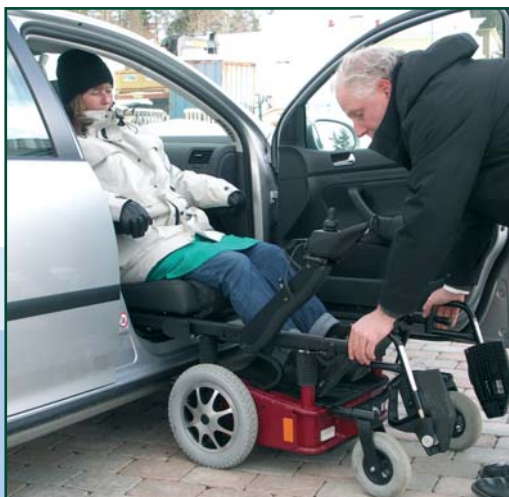
Libérer le châssis du fauteuil roulant de la plaque pivotante.
