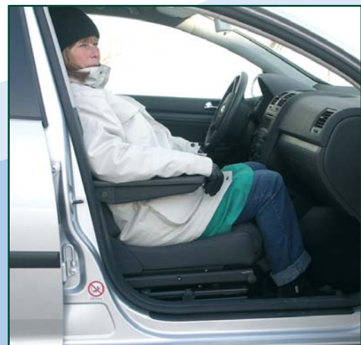
Faire tourner le fauteuil pour le faire entrer dans la voiture, puis serrer la ceinture de sécurité.
